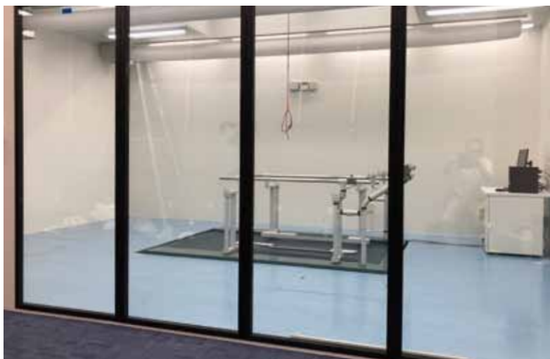
BM-1300 可動手摺り・天井取付非常停止部・ベルト幅130cm、埋込型
