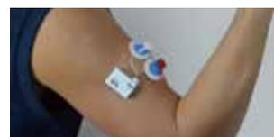
無線筋電図センサ
